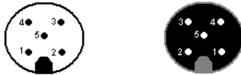
Abbildung 5: Pinbelegung: Einbaustecker / Kupplung für 5-Pol
