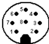
Abbildung 9: Pinbelegung: Einbaustecker / Kupplung für 8-Pol
