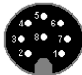
Abbildung 9: Pinbelegung: Einbaustecker / Kupplung für 8-Pol
