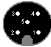
Abbildung 8: Pinbelegung: Einbaustecker / Kupplung für 5-Pol
