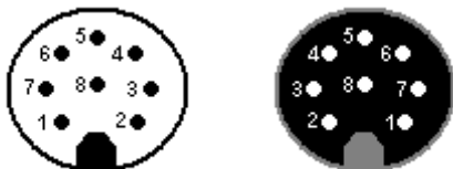
Abbildung 4: Pinbelegung: Einbaustecker / Kupplung für 8-pol
