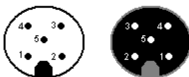
Abbildung 3: Pinbelegung: Einbaustecker / Kupplung für 5-Pol
